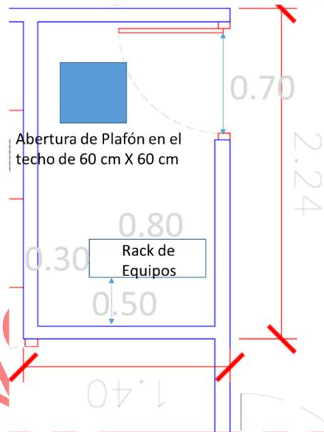
Nota: En la parte superior, en el plafón, se tiene una tubería de desagüe de ¾ plg y una alimentación de 220 V en la pared contraria a la puerta. Se tiene una altura entre el Piso y el Plafón de 3.05 m. No se tiene Piso Falso.
