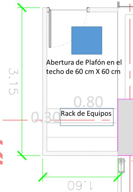
Nota: En la parte superior, en el plafón, se tiene una tubería de desagüe de  $\frac{3}{4}$  plg y una alimentación de 220 V en la parte de arriba también. Se tiene una altura entre el Piso y el Plafón de 3.05 m. No se tiene Piso Falso.
