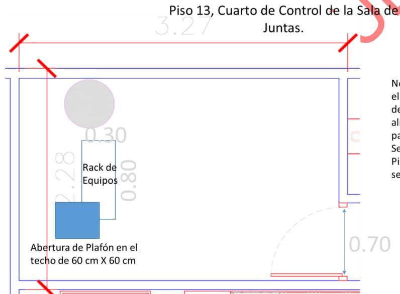
Nota: En la parte superior, en el plafón, se tiene una tubería de desagüe de  $\frac{3}{4}$  plg y una alimentación de 220 V en la parte de arriba también. Se tiene una altura entre el Piso y el Plafón de 3.05 m. No se tiene Piso Falso.
